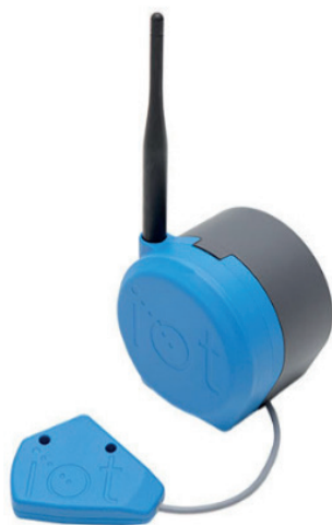
Odečtová hlava se snímačem a vysílací anténou
