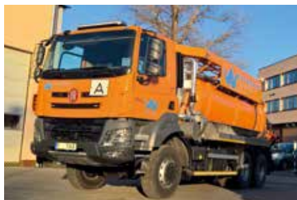
Podvozek TATRA má pohon na všech šest kol, což umožňuje průjezd vozidla i v těžkých terénních podmínkách.
